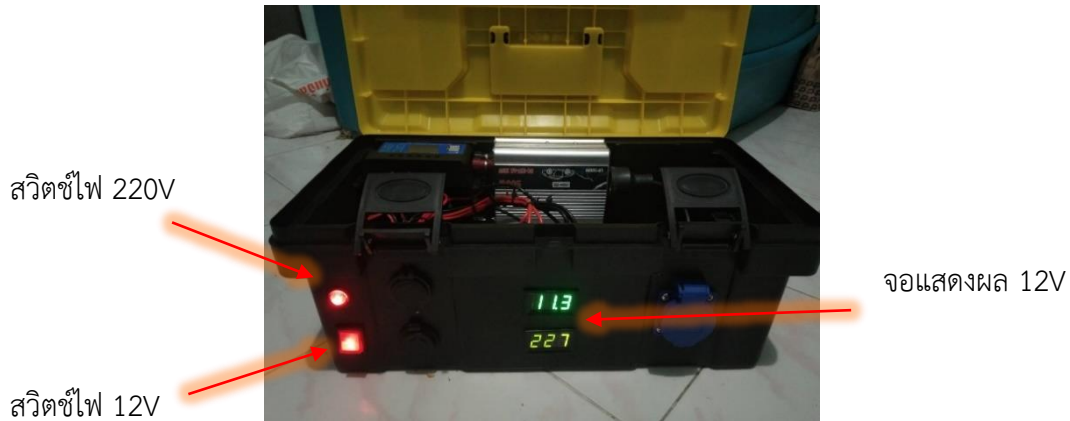
ภาพที่ 3 กล่องจ่ายไฟฟ้าสำรองเคลื่อนที่ ภายนอก
