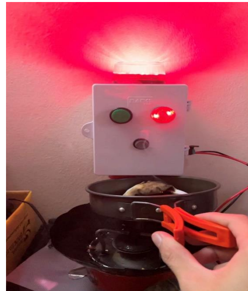
ภาพที่ 4 ทดสอบแจ้งเตือนเมื่อตรวจจับก๊าซและควัน
