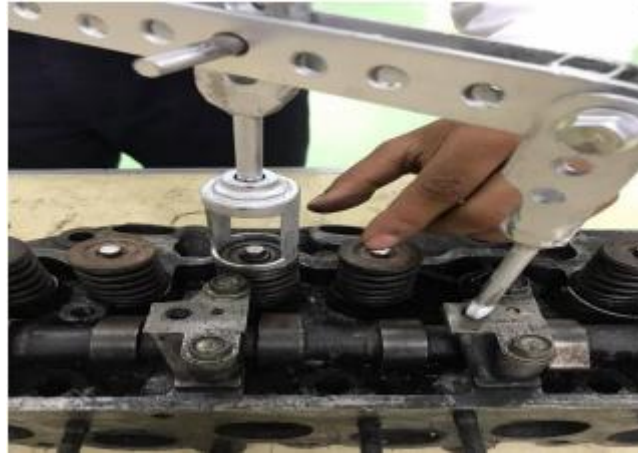
ภาพที่ 1 เครื่องมือถอดสปริงวาล์ว
