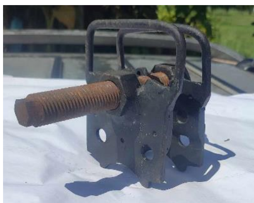
ภาพที่ 4 เครื่องมือต้นลูกสูบคาลิปเปอร์เบรกรถยนต์แบบ 4 พอร์ต
