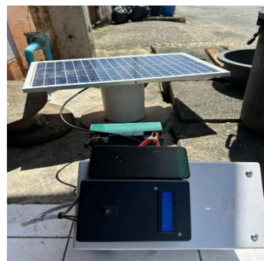
ภาพที่ 2 ผลการทดลองการทดสอบการทำงาน เพื่อดูแรงดัน กระแสไฟฟ้าและกำลังไฟฟ้า
