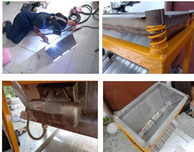
ภาพที่ 3 ขั้นตอนการสร้างเครื่องหยอดทานตะวัน
