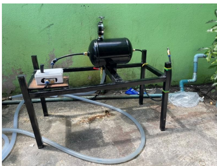
ภาพที่ 3 ระบบถึงลมสำรองเพื่อป้องกันเบรกล็อก
