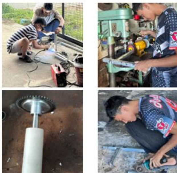
ภาพที่ 3 ขั้นตอนการสร้างเครื่องรีดใบกะพ้อ
