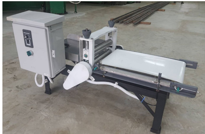
ภาพที่ 4 เครื่องรีดปลาเกลือกึ่งอัตโนมัติ
